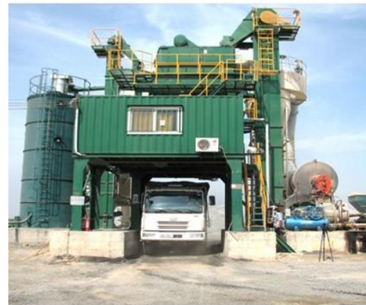
Trạm sản xuất bê tông nhựa nóng DongSung (120 tấn/giờ)
