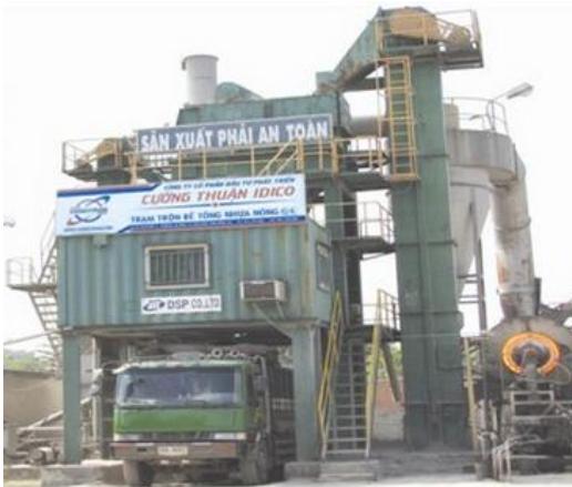
Trạm sản xuất bê tông nhựa nóng DongSung (90 tấn/giờ)
